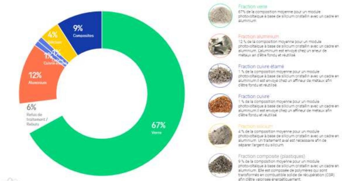
Figure 8. Répartition des différentes fractions composant un panneau solaire photovoltaïque, SOREN
